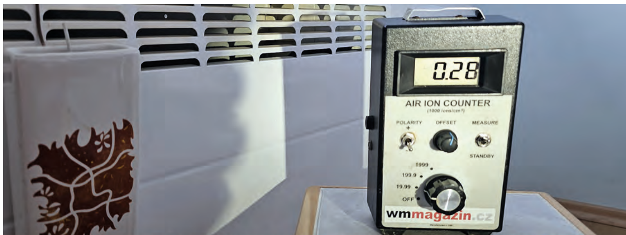
Elektrický přímotop u lůžka: vzdušné lehké ionty 280 i+/cm 3
